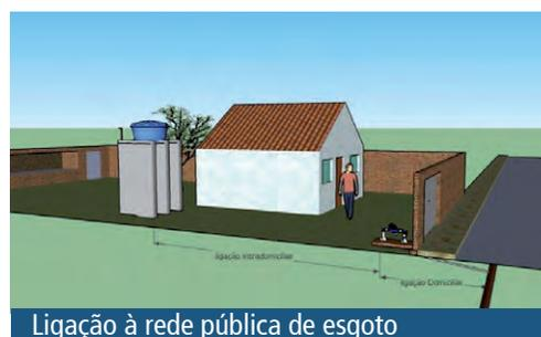
Em relação ao esgotamento sanitário, poderá ser construída ligação à rede pública ou tanque séptico/filtro biológico, sumidouro ou fossa ecológica (ver imagens). Independentemente das melhorias adotadas, ainda poderão ser incluídos itens como sistema para reuso da água e lixeira.
